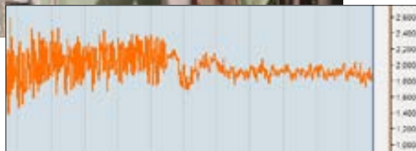
Utsignal Promag P500 före och efter adaptiv förstärkning.
