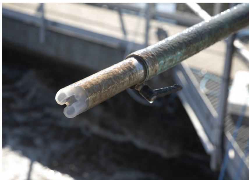
Turbimax CUS50D är en optisk "absorberande" givare
