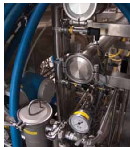
De två filtrena i testanläggningen kan ersättas med olika membran, så att olika filtreringsmetoder kan testas.
