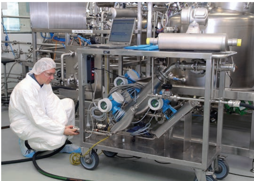
Endress+Hauser kan skräddarsy kalibreringen så att den passar dina behov. Med vår mobila kalibreringsrigg har vi möjlighet att utföra kalibrering on-site.
