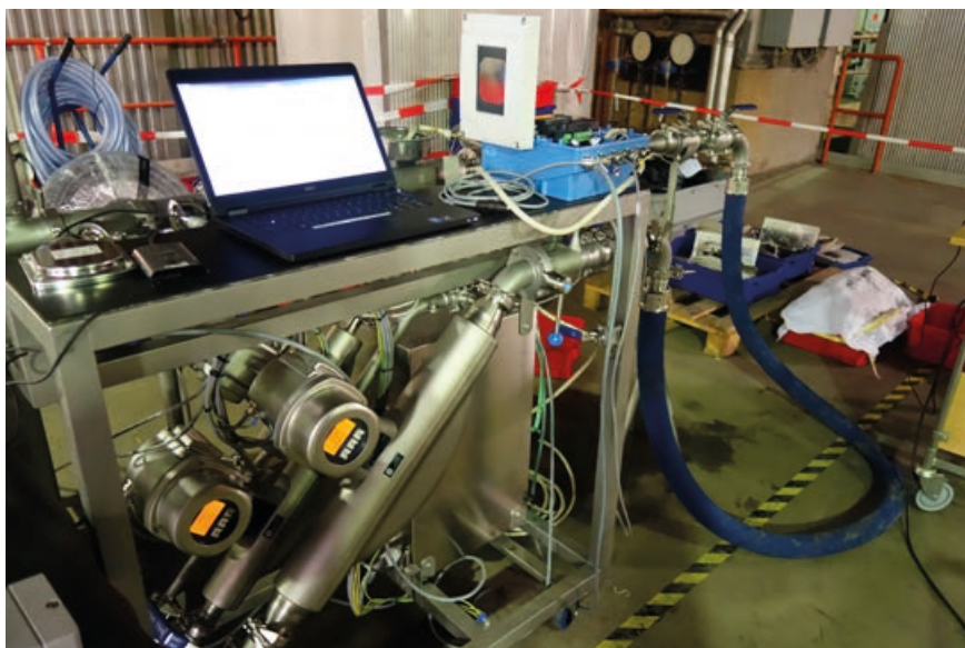
Kalibreringsriggen består av ett slutet system med en 300-liters vattentank, pump, referensinstrument samt system för styrning och datainsamling.
